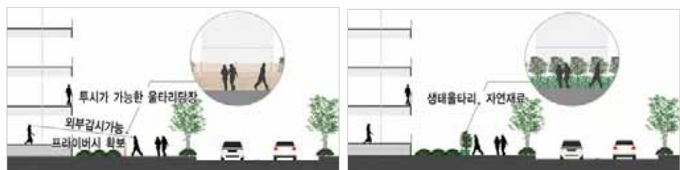
▲권장 : 투시형 담장 설치
